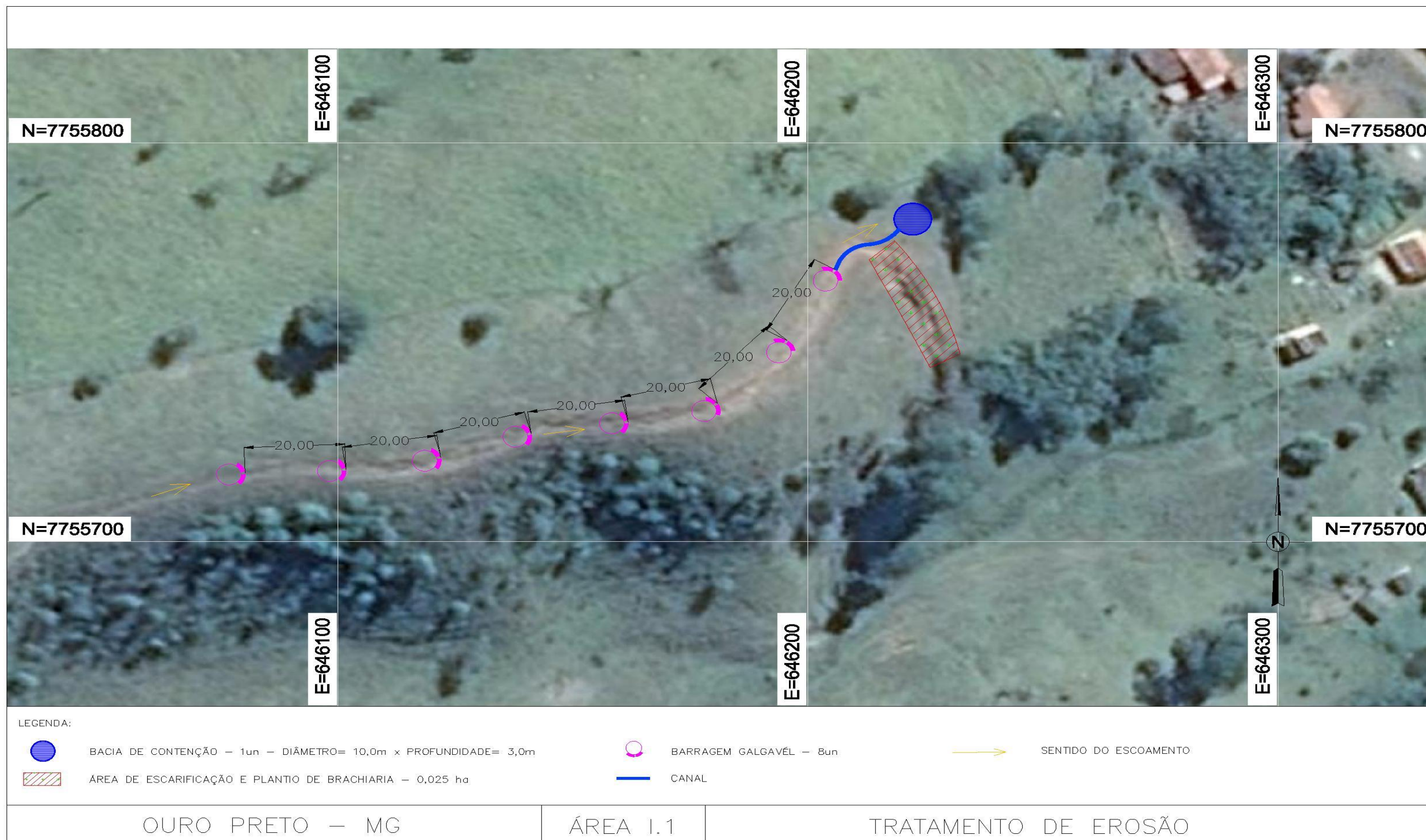
Figura 6.6 – Projeto de recuperação de processo erosivo
