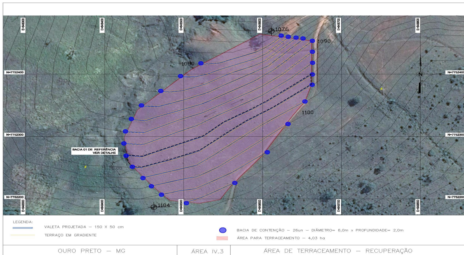
Figura 6.32 – Projeto de recuperação – terraceamento
