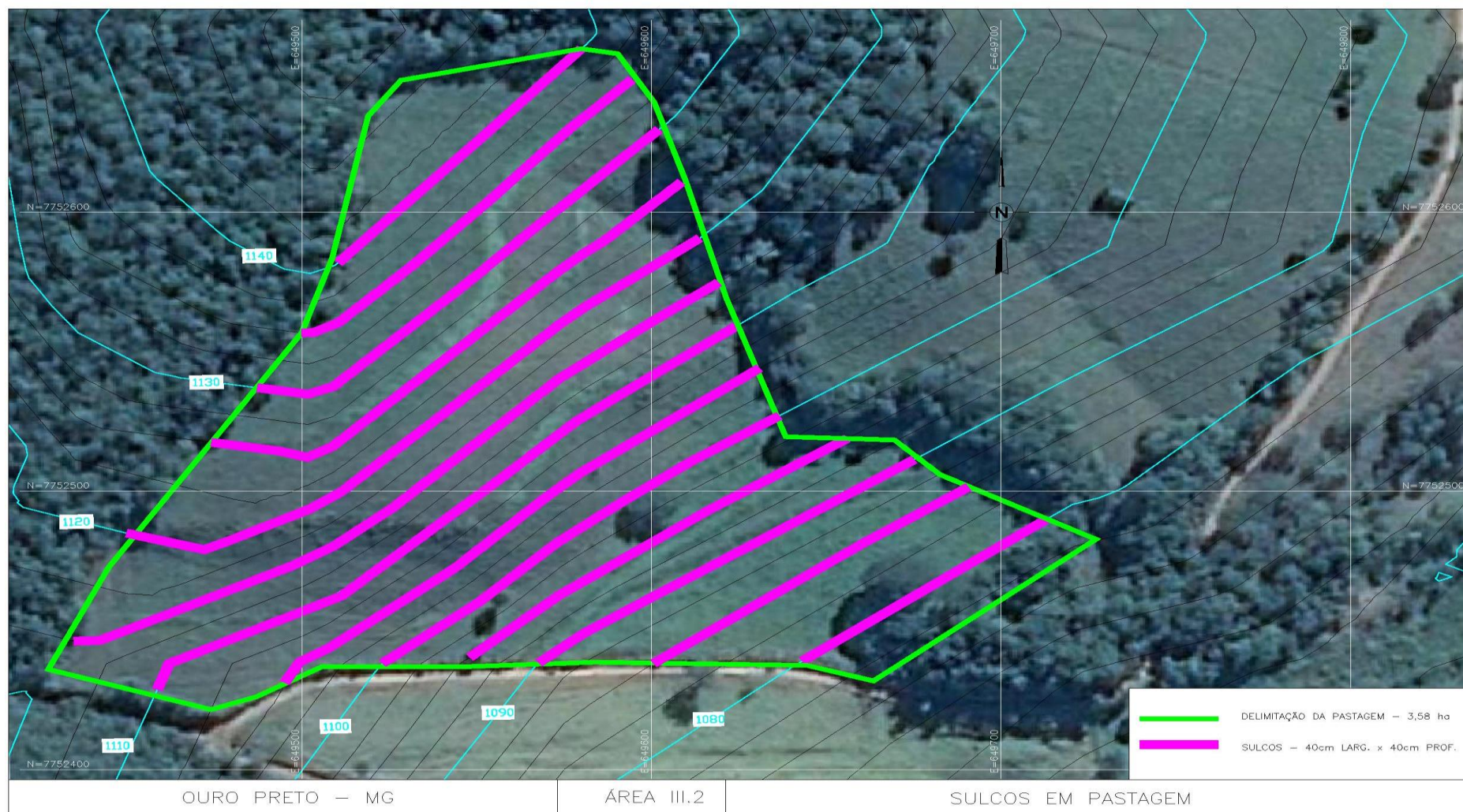
Figura 6.24 – Projeto de implantação de sulcos em contorno
